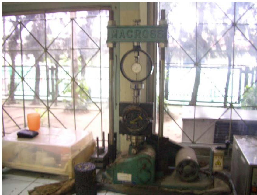
ภาพผนวกที่ ข 2 เครื่องมือทดสอบมาร์แชลล์ ติดตั้งอุปกรณ์ทดสอบ Stability Test
