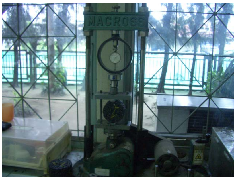
ภาพผนวกที่ ข 14 เครื่องมือทดลองมาร์แชลล์ ติดตั้งอุปกรณ์ทดสอบ Indirect Tensile
