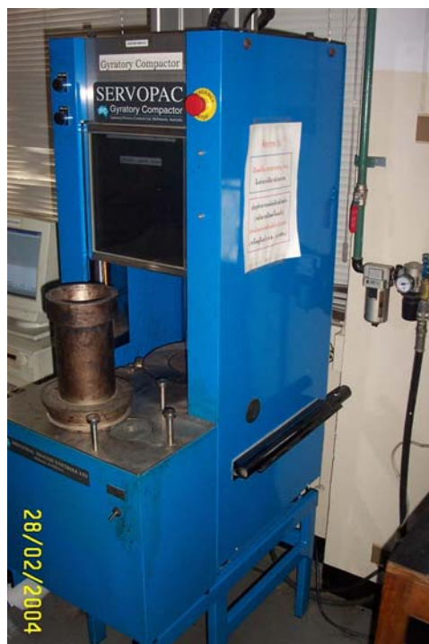
ภาพผนวกที่ ข 6 เครื่องบดอัด Gyratory Compactor ของสำนักวิจัยและพัฒนาทาง กรมทางหลวง
