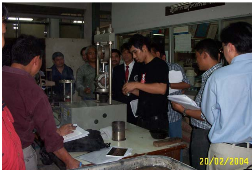
ภาพผนวกที่ ข 1 เครื่องมือทดสอบเสถียรภาพและการไหลของแอสฟัลต์คอนกรีตด้วยวิธีมาร์แชลล์
