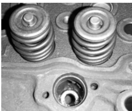
ภาพที่ 26 บริเวณรูที่ถอดปลอกหัวฉีดน้ำมันดีเซลออก
