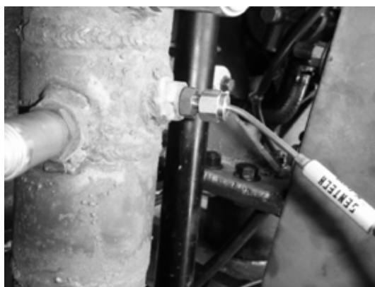
ภาพที่ 16 การติดตั้งเครื่องมือวัดอุณหภูมิไอเสียบริเวณท่อไอเสีย
