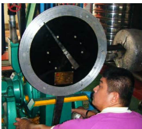
ภาพที่ 35 เข็มบนหน้าปัดแสดงค่าแรงบิดเบรก
