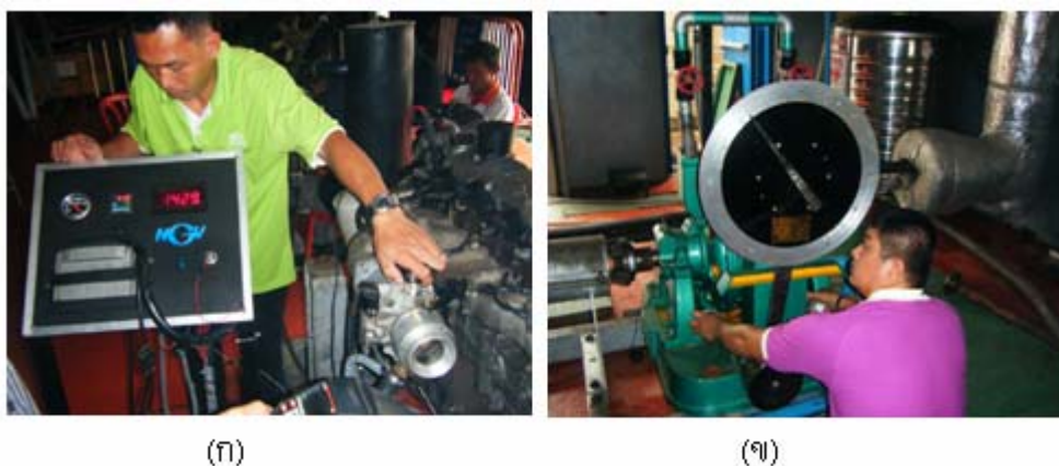
ภาพที่ 34 การเปิดเครื่องเพื่อรักษาอัตราเร็วรอบเครื่องยนต์ตามต้องการ (ก) และการปรับปริมาณน้ำเข้าและออกไดนาโมมิเตอร์ (ข)
