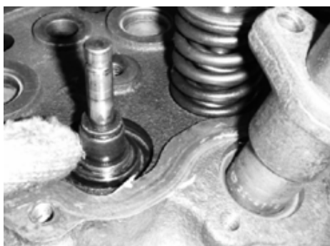
ภาพที่ 30 ยางกันน้ำมันปลอกวาล์วไอดีของเครื่องยนต์ดีเซลก่อนการตัดแปลง
