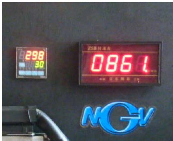
ภาพที่ 36 จอมอนิเตอร์แสดงอุณหภูมิไอเสีย (ซ้าย) และอัตราเร็วรอบเครื่องยนต์ (ขวา)
