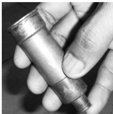
ภาพที่ 25 ปลอกหัวฉีดของเครื่องยนต์ดีเซลก่อนการดัดแปลง
