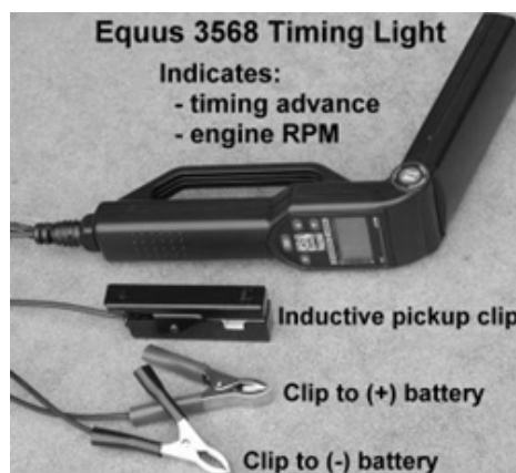
ภาพที่ 17 เครื่องมือวัดจังหวะการจุดระเบิด
