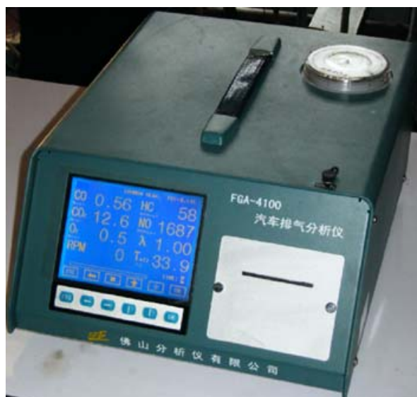
ภาพที่ 37 จอมอนิเตอร์แสดงผลพิษของไอเสียแต่ละชนิด และค่าอัตราส่วนอากาศต่อเชื้อเพลิงสัมพัทธ์
