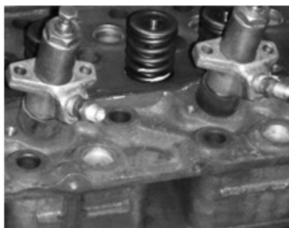
ภาพที่ 24 หัวฉีดน้ำมันดีเซลสวมอยู่กับปลอกหัวฉีดของเครื่องยนต์ดีเซลก่อนการดัดแปลง
