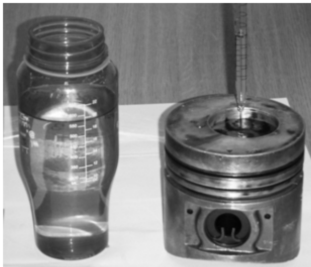
ภาพที่ 21 แสดงการวัดปริมาตรหลุมลูกสูบก่อนการตัดแปลง
