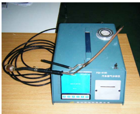
ภาพที่ 15 เครื่องมือวัดปริมาณไอเสียชนิดรังสีอินฟราเรดแบบไม่กระจาย
