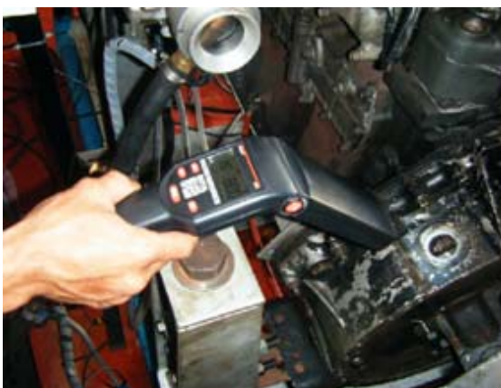
ภาพที่ 33 การวัดจังหวะการจุดระเบิดที่รอบเดินเบาคด้วยเครื่องมือวัดจังหวะการจุดระเบิด
