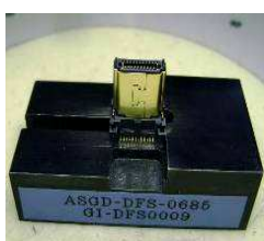
วางชิ้นงานบนเกทพิช ตรวจสอบระยะหางแถวบน ตรวจสอบ ระยะหางแถวล่าง ข้อกำหนดระยะหาง
