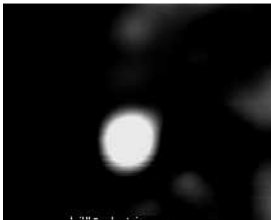
ภาพที่ 33 อนุภาคเขม่าป็นที่มีลักษณะอนุภาคค่อนข้างกลม มีความสว่างจ้า มีธาตุ PbSb เป็นองค์ประกอบ
