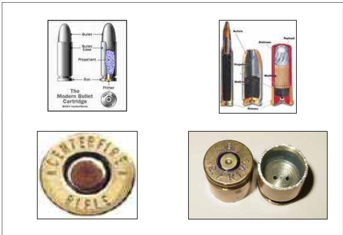
ภาพที่ 4 โครงสร้างกระสุนปืนแบบ Center fire
