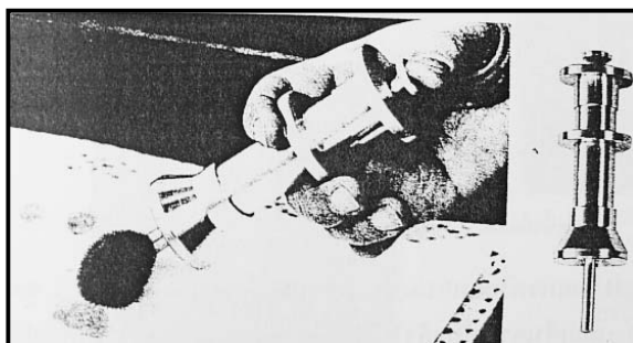
ภาพที่ 40 แปรแม่เหล็กใช้กับผงฝุ่นที่มีส่วนผสมของแม่เหล็ก
