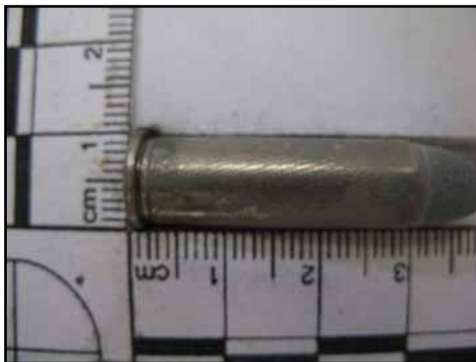
ภาพที่ 73 แสดงการปรากฏของรอยลายนิ้วมือแฝงบนกระสุนปืนโลหะสีเงินขนาด .38 ณ เวลาที่ 1 ชม. โดยใช้วิธี Gun bluing ( ที่จัดทำขึ้นเอง)
