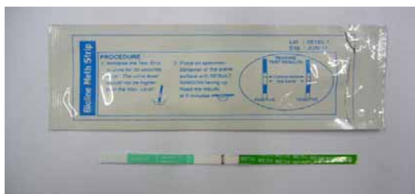
ภาพที่ 20 ทดสอบน้ำลายหลังการเสพยาบ้าที่เวลา 15 นาที ด้วย strip test (ครั้งที่ 1)
