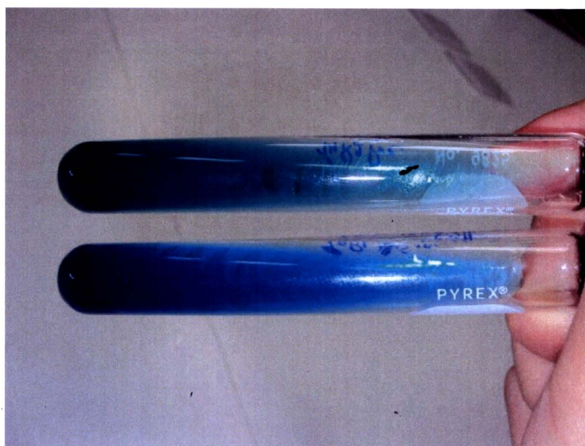
ภาพที่ 8 ผลการทดสอบ บนอาหาร Citrate สีน้ำเงินให้ผลเป็น Positive และสีเขียวให้ผลเป็น Negative
