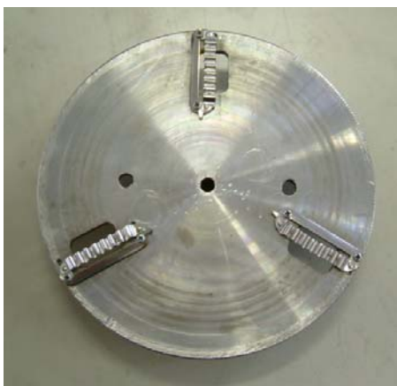
ภาพที่ 5.2 ชูดจานใบมีดแบบ 3 ใบ
