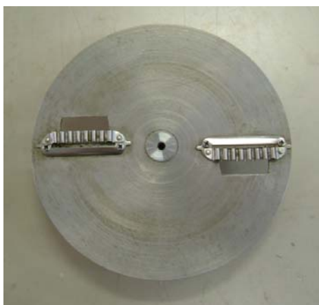
ภาพที่ 5.3 ชูดจานใบมีดแบบ 2 ใบ
