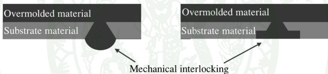
ภาพที่ 14 การออกแบบแม่พิมพ์ให้มีตำแหน่งยึดเกาะโดยทางกล
