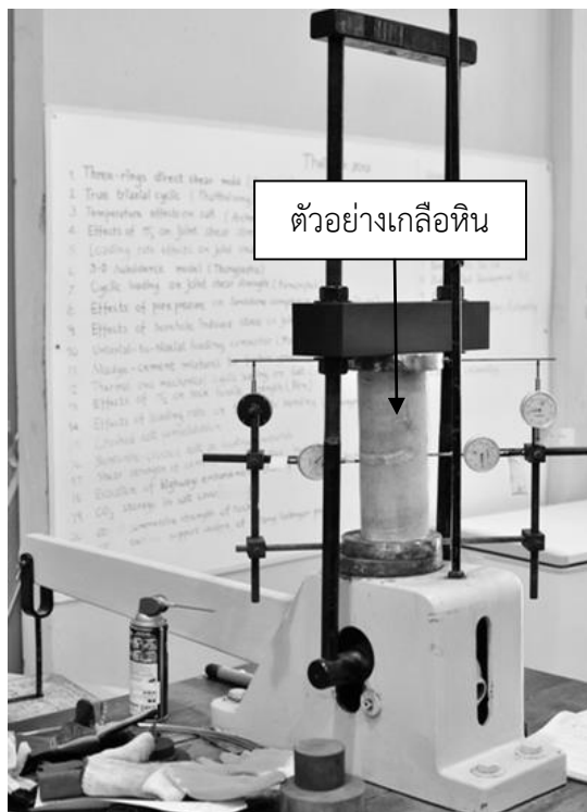
รูปที่ 4.1 ตัวอย่างเกลือหินขณะทำการทดสอบภายในเครื่องทดสอบการเคลื่อนไหล ในแกนเดียวของตัวอย่างเกลือหินในห้องปฏิบัติการที่อุณหภูมิ 30°C
