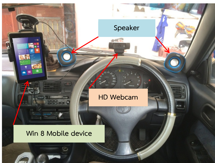
รูปที่ 3.32 การติดตั้งกล้องวิดีโอในยานพาหนะ
