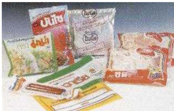
ภาพที่ 11 ฟิล์มพลาสติกที่ใช้ในการทำถุงประเภทหลายชั้น ที่มา: กรมส่งเสริมการเกษตร (ม.ป.ป.)
