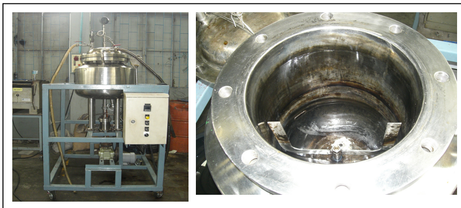
ภาพที่ 3-1 หม้อต้มเชื้อพร้อมชุดควบคุม
