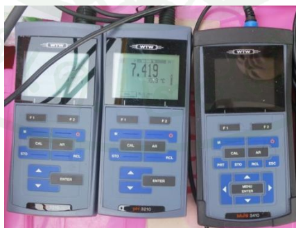
ภาพที่ 3 เครื่องวัดคุณภาพน้ำภาคสนาม (DO meter, Conductivity meter, pH meter)
