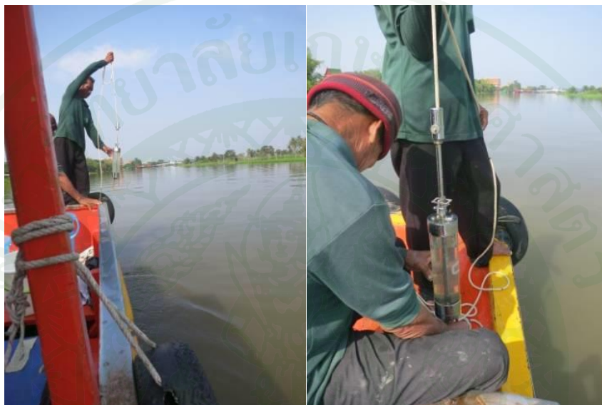
ภาพที่ 6 การเก็บตัวอย่างน้ำโดยกระบอกเก็บตัวอย่างน้ำ
