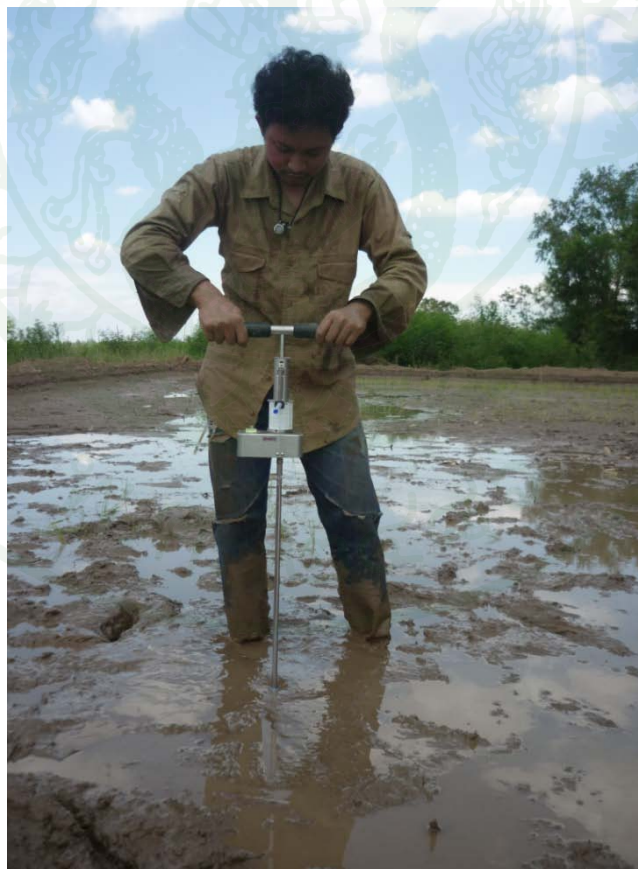
ภาพผนวกที่ ค8 วัดความแข็งของดินด้วย Cone penetrometer
