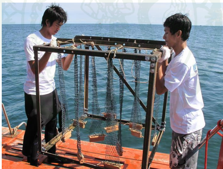
ภาพที่ 23 ปะการังเทียมโครงเหล็กทรงลูกบาศก์ที่น้ำหนักไม่มาก สามารถเคลื่อนย้ายได้สะดวก
