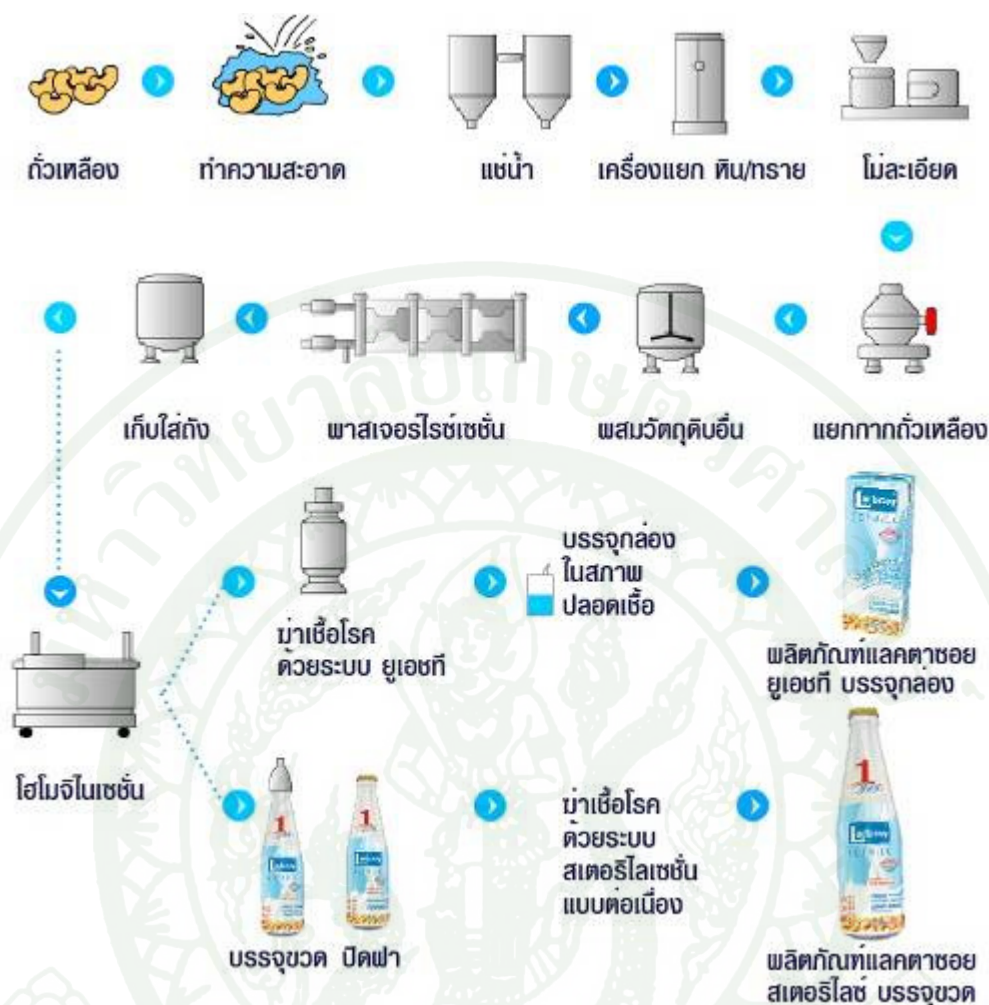
ภาพที่ 3.1 กระบวนการผลิตนมถั่วเหลืองของบริษัท แลคตาซอย จำกัด ที่มา: แลคตาซอย (2556)
