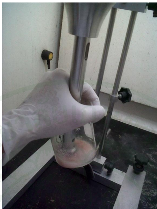
ภาพผนวกที่ ข3 การปั่นตัวอย่างเนื้อด้วยเครื่อง homogenizer
