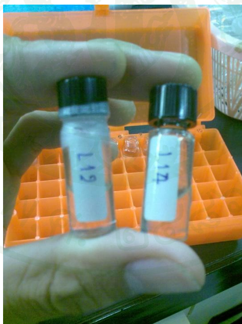
ภาพผนวกที่ ข4 การเก็บตัวอย่างที่สกัดได้ในขวด vial ที่มีฝาปิดแล้วพันด้วยพาราฟิล์มป้องกันการระเหย
