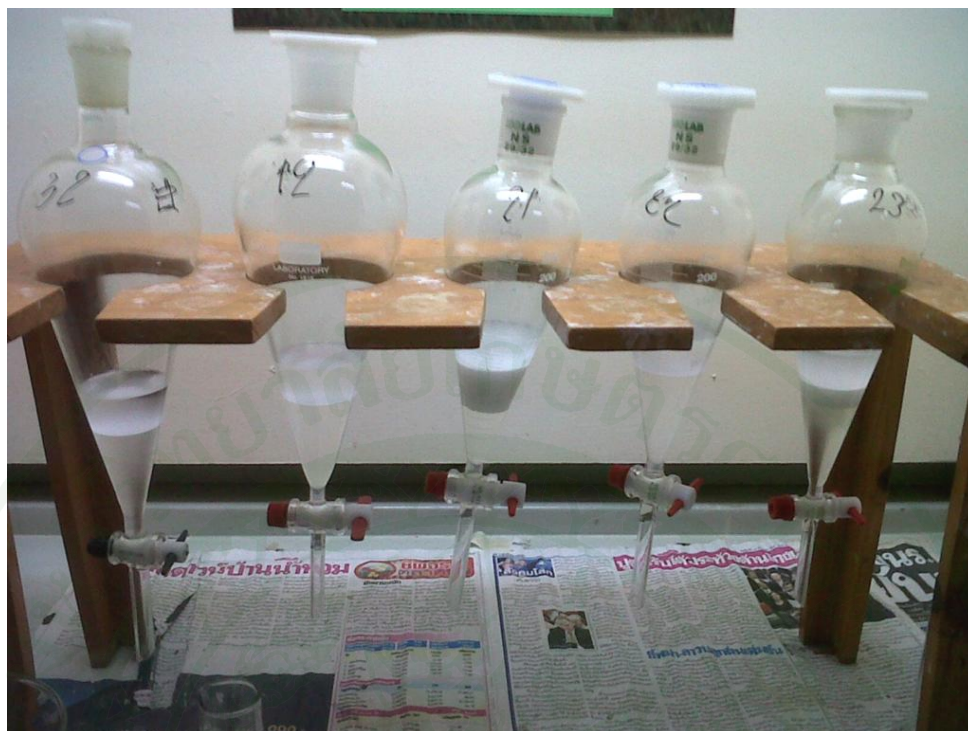
ภาพผนวกที่ ข2 ตัวอย่างการสกัดไขมันขณะตั้งทิ้งไว้รอการแยกชั้นหลังจากเติมน้ำกลั่น 20 มิลลิลิตร
