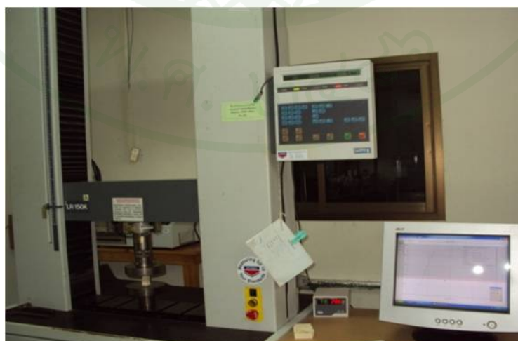
ภาพที่ 10 แสดงเครื่องทดสอบสากลคุณสมบัติเชิงกลของไม้
