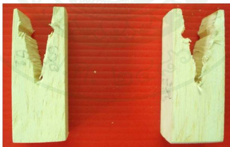
ภาพที่ 19 ตัวอย่างชิ้นไม้ขนาด 2 \times 2 \times 4.5 ซม. และการบากเพื่อทดสอบการฉีก
