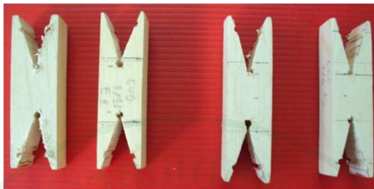
ภาพที่ 15 ตัวอย่างชิ้นไม้ขนาด 2 x 2 x 7 ซม. และการบากไม้เพื่อทดสอบแรงดึงตั้งฉากเส้น
