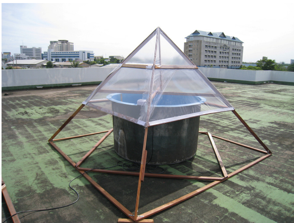
ภาพผนวกที่ 6 การทดลองที่ 1: ลักษณะของโครงหลังคาคลุมด้วยพลาสติกใส
