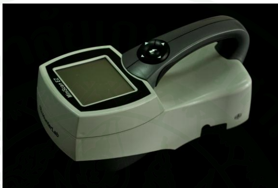
ภาพที่ 26 เครื่อง MiniScan XE Sensor
