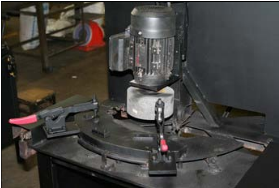
ภาพที่ 3-25 บริเวณของโต๊ะจับยึดมีดเพื่อเจียรคมตัด
