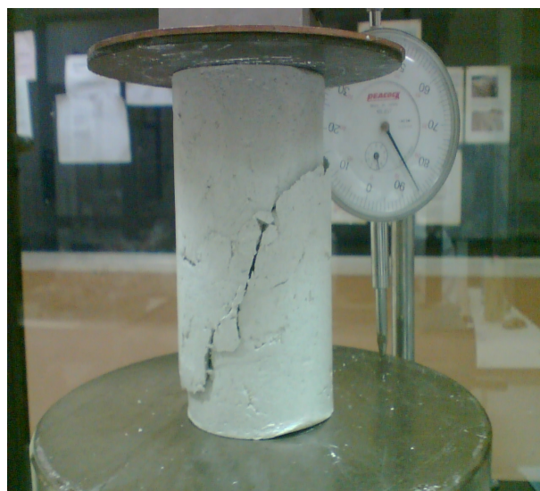
ภาพที่ ก.6 ลักษณะการวิบัติของตัวอย่างทดสอบ
