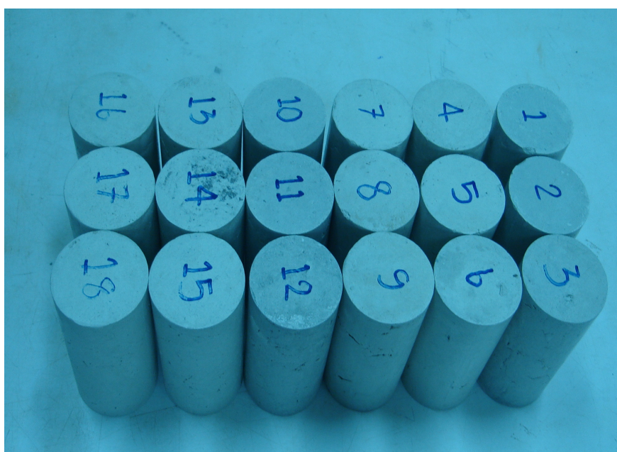
ภาพที่ ก.4 ตัวอย่างสำหรับเตรียมทดสอบ Unconfined Compression Test
