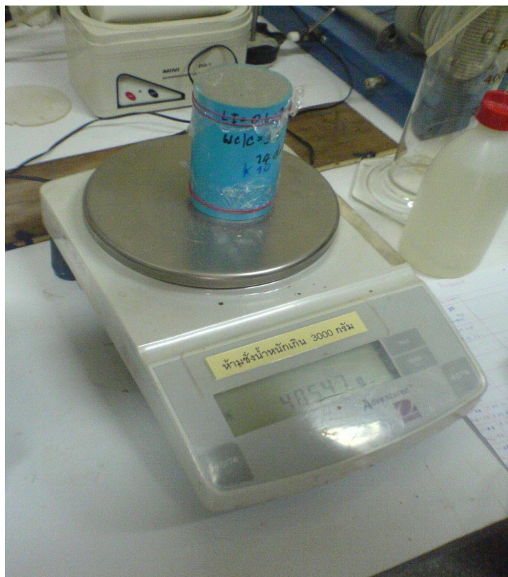
ภาพที่ ก.3 การควบคุมหน่วยน้ำหนักของตัวอย่างทดสอบ
