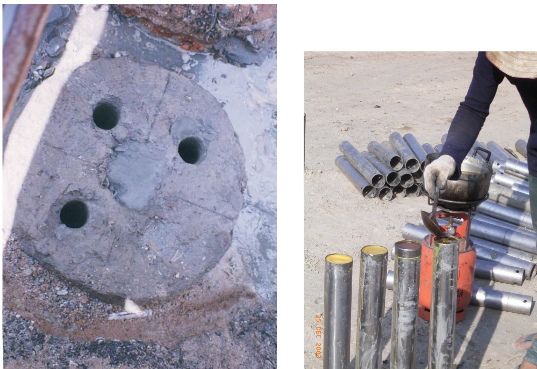
ภาพที่ 6.5 ลักษณะการ Coring ในสนาม
