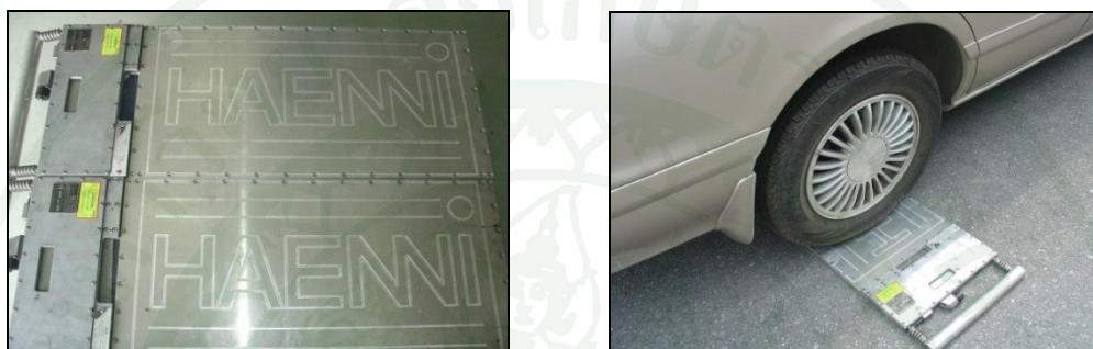
ภาพที่ 14 เครื่องชั่งน้ำหนักรถยนต์และการชั่งน้ำหนักรถยนต์
