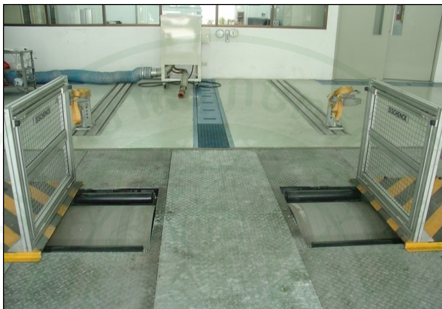
ภาพที่ 3 แชสซิสไดนาโมมิเตอร์ (Chassis dynamometer)
