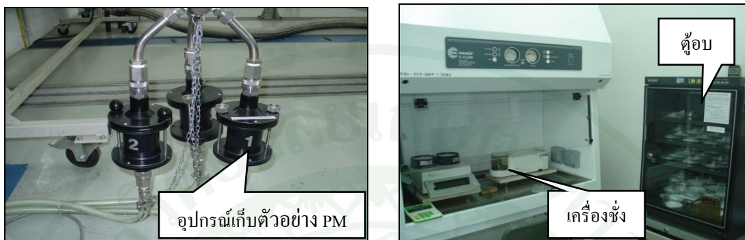
ภาพที่ 8 อุปกรณ์เก็บตัวอย่าง เครื่องชั่ง และตู้อบกระดาดตัวอย่างสารมลพิษอนุภาค
