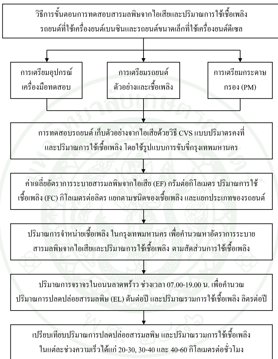
ภาพที่ 15 แผนผังการวิจัยทดสอบอัตราการระบายสารมลพิษจากไอเสียและปริมาณการใช้เชื้อเพลิง รถยนต์ที่ใช้เครื่องยนต์เบนซิน และรถยนต์ขนาดเล็กที่ใช้เครื่องยนต์ดีเซล
