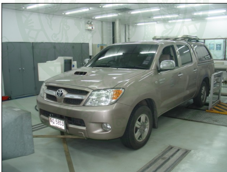
ภาพผนวกที่ ค4 การทดสอบสารมลพิษจากไอเสียรถยนต์ขนาดเล็กที่ใช้เครื่องยนต์ดีเซล
