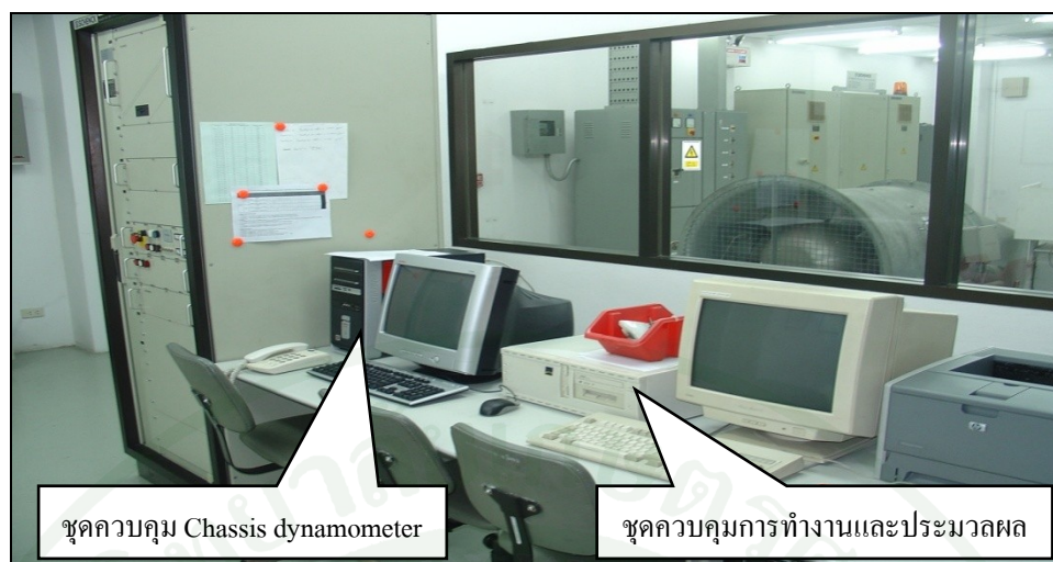
ภาพที่ 11 ระบบควบคุมการทำงานและประมวลผลข้อมูลการทดสอบสารมลพิษจากรถยนต์
