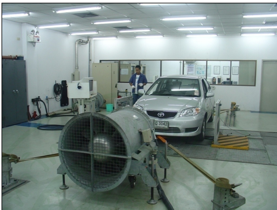
ภาพผนวกที่ ค3 การทดสอบสารมลพิษจากไอเสียรถยนต์ที่ใช้เครื่องยนต์เบนซิน
