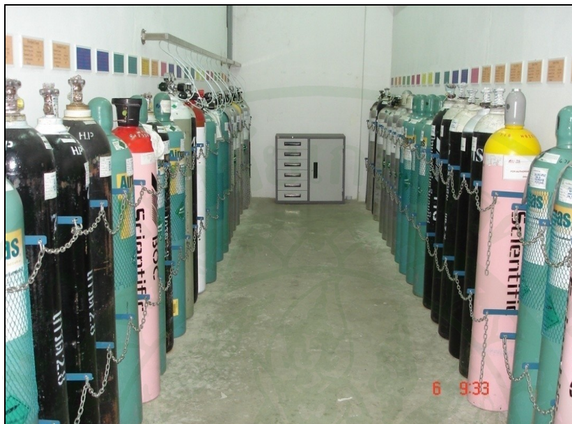
ภาพที่ 12 แก๊สมาตรฐานสำหรับปรับเทียบเครื่องมือ
