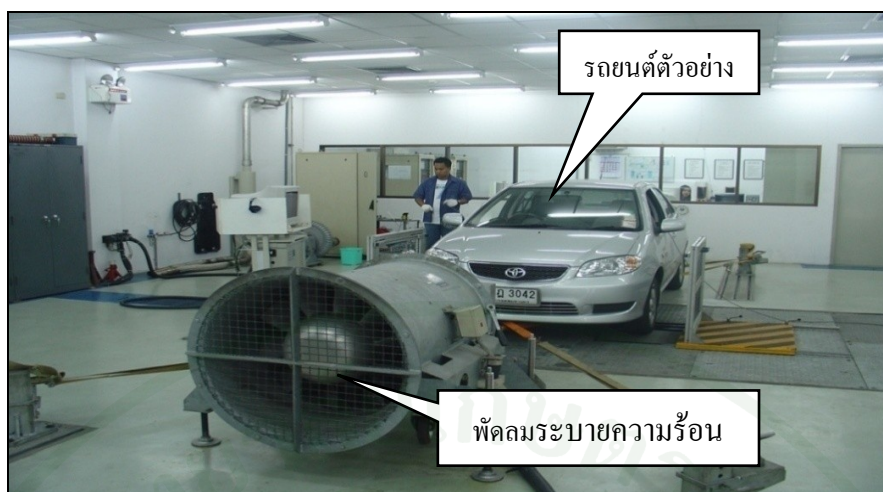
ภาพที่ 4 พัดลมระบายความร้อนรถยนต์ (Cooling fan)
