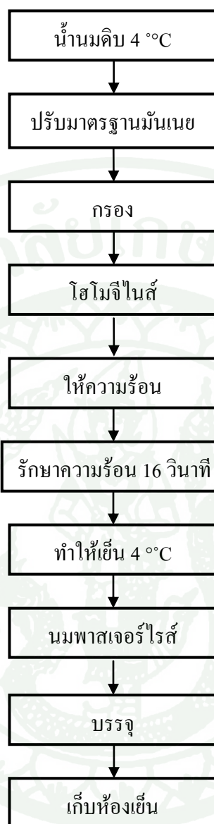
ภาพที่ 2 กระบวนการแปรรูปนมพาสเจอร์ไรส์
