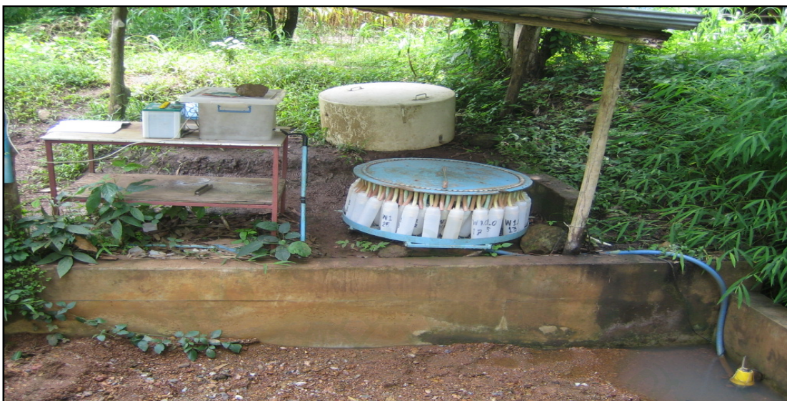
ภาพที่ 13 การเก็บตัวอย่างตะกอนแขวนลอย และวัดน้ำท่า ในพื้นที่ลุ่มน้ำห้วยหมาโน จังหวัดแพร่
