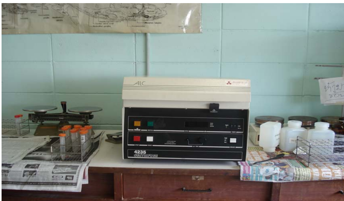
ภาพที่13 เครื่องปั่นเหวี่ยง (centrifuge) และอุปกรณ์ที่ใช้ในการตรวจหาไข้พยาริโดยวิธีกาคตะกอน โดยการปั่น (formalin ethyl acetate centrifugal sedimentation concentration technique)
