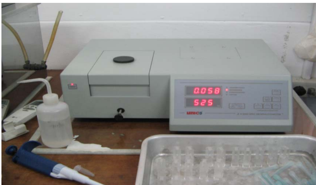
ภาพที่14 เครื่อง spectrophotometer และอุปกรณ์ที่ใช้ในการวิเคราะห์หาปริมาณสารแทนนินใน กระถินทดลอง
