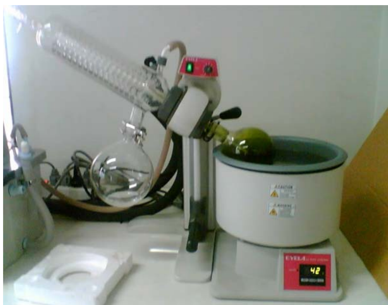
ภาพผนวกที่ ข4 การระเหยแห้งโดยใช้เครื่อง rotary evaporator
