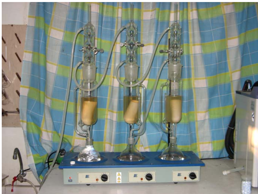
ภาพที่ 7 การสกัดสารแบบต่อเนื่องด้วยเครื่อง soxhlet apparatus
