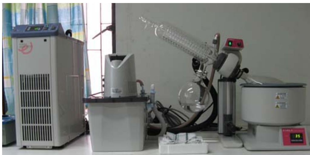
ภาพที่ 8 การระเหยตัวทำละลายด้วยเครื่อง rotary evaporator
