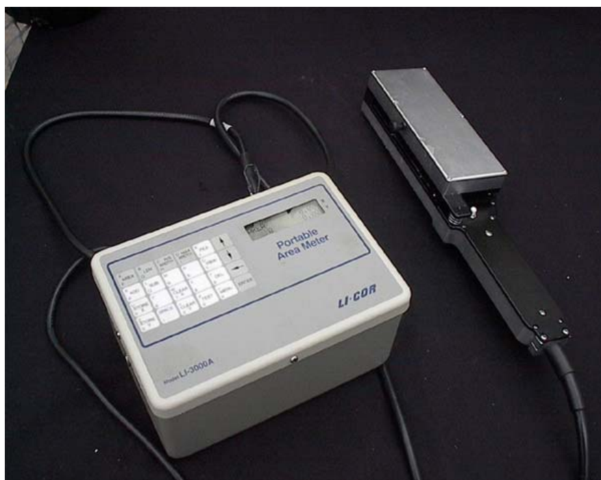
ภาพที่ 12 เครื่องวัดพื้นที่ใบ (LI-3000A Portable Area Meter)
