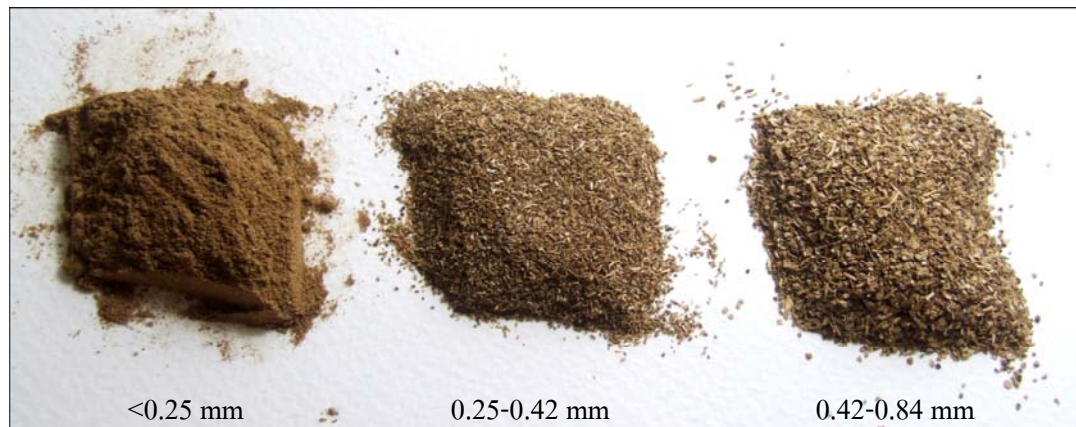
ภาพที่ 6 เปลือกผลสูบค้ำที่ผ่านการบดและร่อนผ่านตะแกรงขนาดต่างๆ
