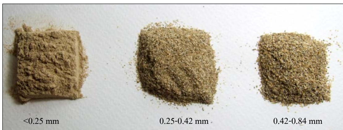
ภาพที่ 7 เปลือกค้ำต้นสูบค้ำที่ผ่านการบดและร่อนผ่านตะแกรงขนาดต่างๆ
