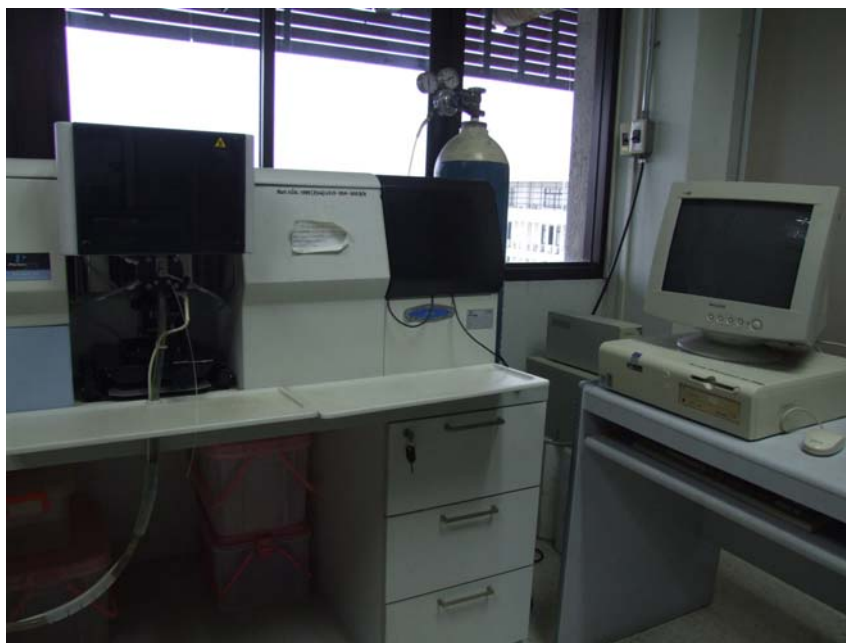
ภาพผนวกที่ จ3 เครื่อง Atomic Absorption Spectrophotometer (AAS) บริษัทผู้ผลิต Perkin รุ่น Analyst 300
