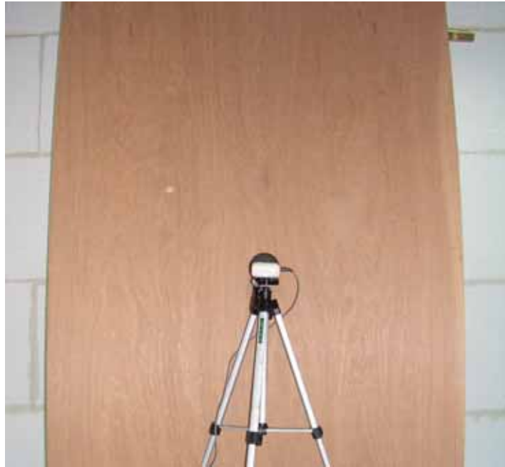
ภาพผนวกที่ ข7 การตรวจวัดการลดระดับความดังเสียงของไม้อัด
