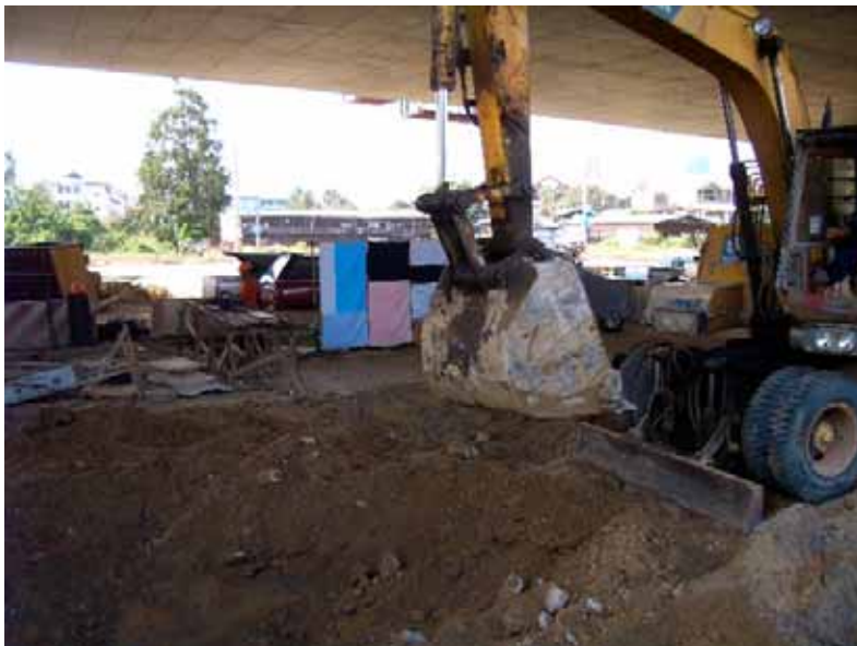
ภาพผนวกที่ ข13 การตรวจวัดการลดระดับความดังเสียงของเศษผ้าในภาคสนาม (เสียงจาก Backhoe)
