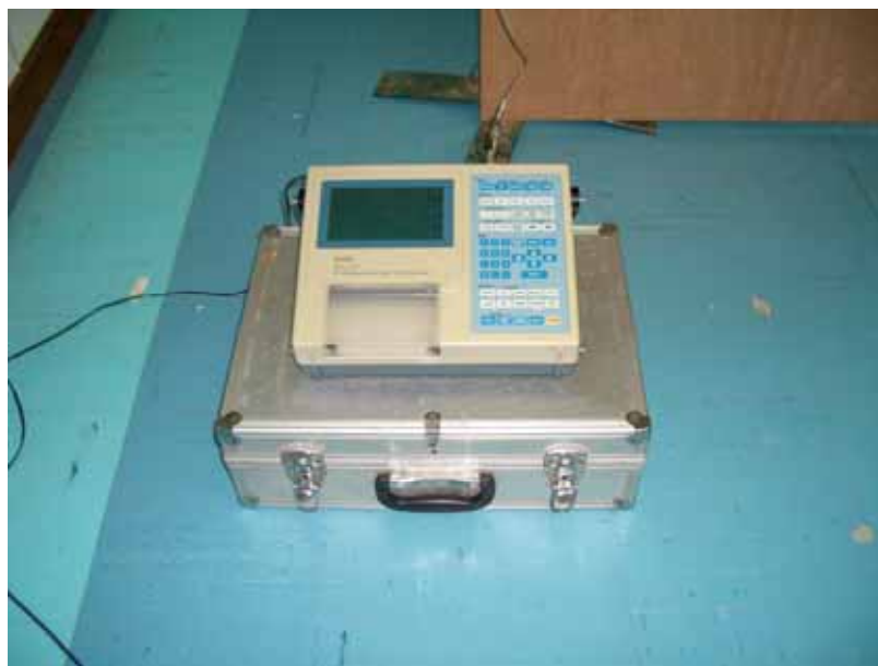
ภาพผนวกที่ ข3 เครื่องวิเคราะห์ความถี่เสียง ยี่ห้อ RION รุ่น SA-29
