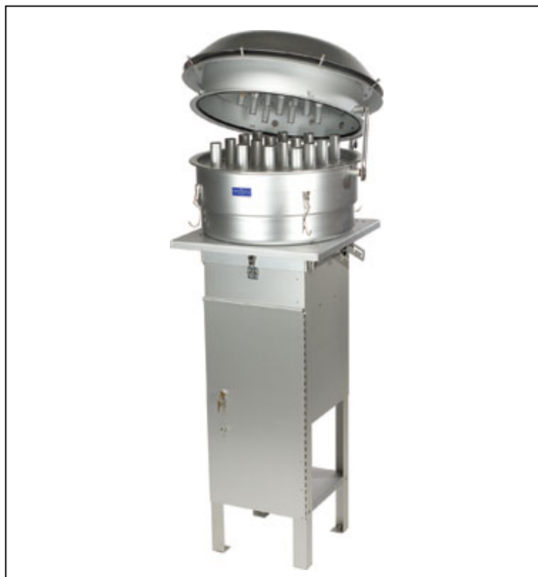
ภาพที่ 10 เครื่องเก็บตัวอย่างฝุ่นละอองขนาดไม่เกิน 10 ไมครอน
