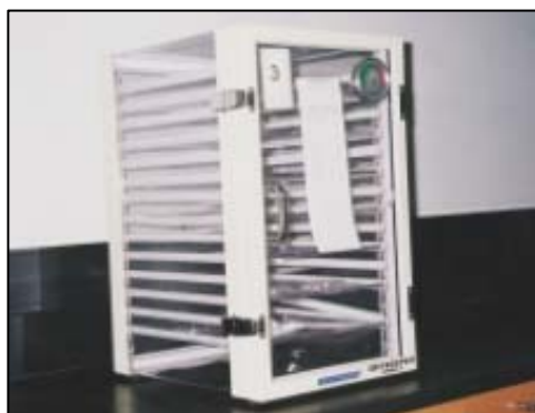
ภาพที่ 14 ตู้ดูดความชื้น
