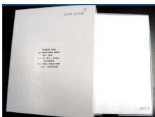
ภาพที่ 12 กระดาษกรองชนิด Glass fiber filter
