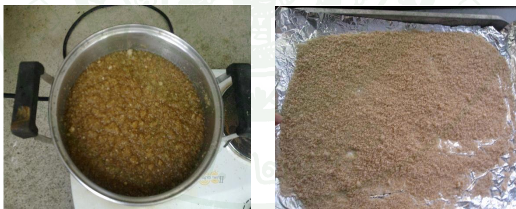
ภาพที่ 5 การสกัดโคโคซาน(การกำจัดหมู่อะซิทิล (Deacetylation))
