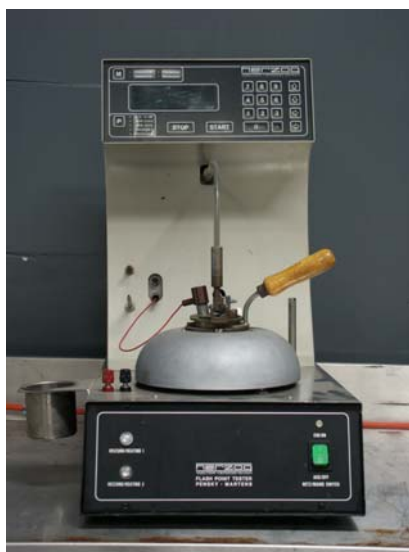
ภาพที่ 8 Pensky-Martens closed flash tester เครื่องมือทดสอบจุดวาบไฟ
