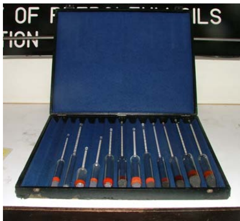
ภาพที่ 5 ไสโครมิเตอร์ เครื่องมือทดสอบความหนาแน่น
