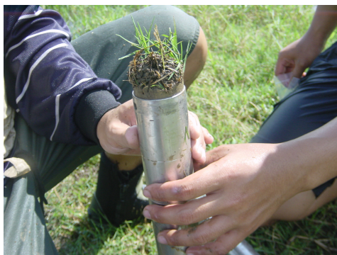
ภาพที่ 3 การเก็บตัวอย่างดินด้วยกระบอกรีดดิน (hand corer) เพื่อศึกษาคุณสมบัติของดินพื้นท้องน้ำทั้งทางกายภาพและเคมี
