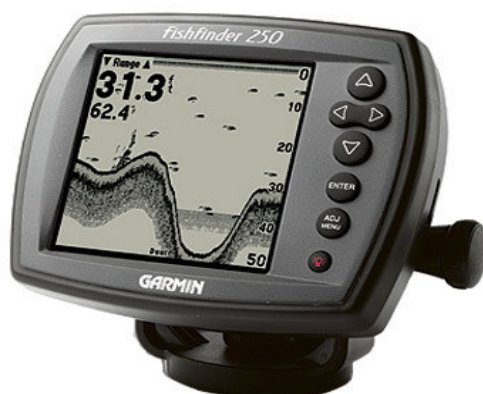
ภาพที่ 4 เครื่องมือวัดความลึกของน้ำ (echo sounder) ใช้ประกอบกับเรือเก็บตัวอย่าง
