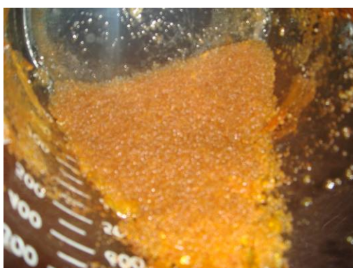
ภาพที่ 38 สารละลายหนืดที่ผ่านกระบวนการกวนในน้ำมันและให้ความร้อนนาน 45 นาที
