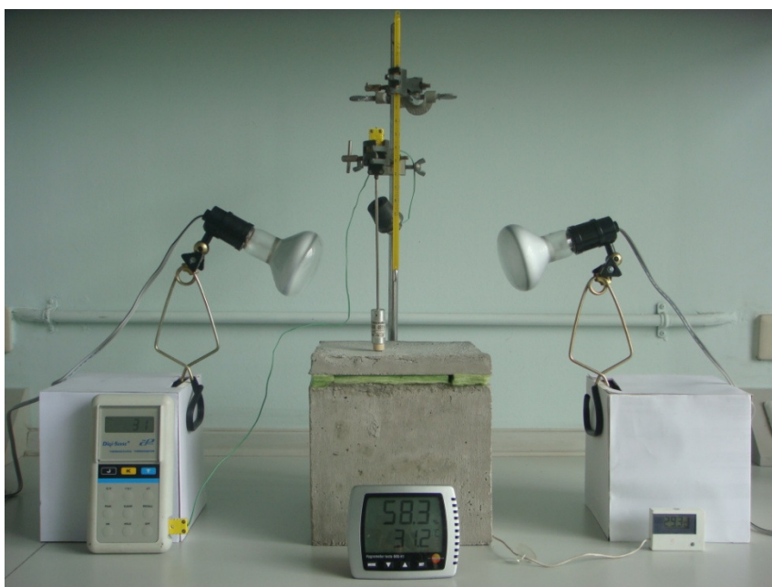
ภาพที่ 21 ภาพการจัดอุปกรณ์เพื่อทำการทดสอบประสิทธิภาพของ Paraffin / Fly Ash Composite PCMs
