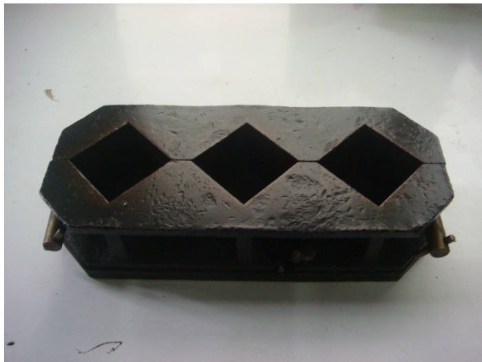
ภาพที่ 23 แม่แบบลูกบาศก์ (Mold) ขนาด 50 x 50 มิลลิเมตร
