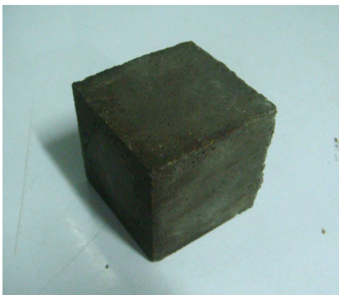
ภาพที่ 58 สี่เหลี่ยมลูกบาศก์ขนาด 50 x 50 x 50 มิลลิเมตร
