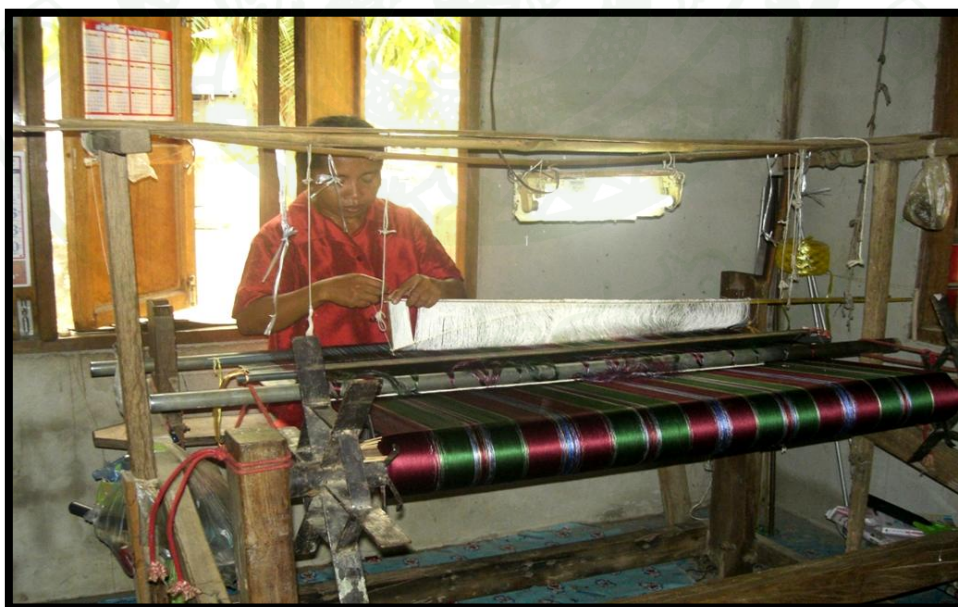
ภาพผนวกที่ 8 การเก็บตะกอ (วิธีบังคับเส้นด้ายขึ้นให้ขึ้นและลง เพื่อที่จะให้ด้ายพุ่งเข้าไปขัดกับด้ายยืน)
