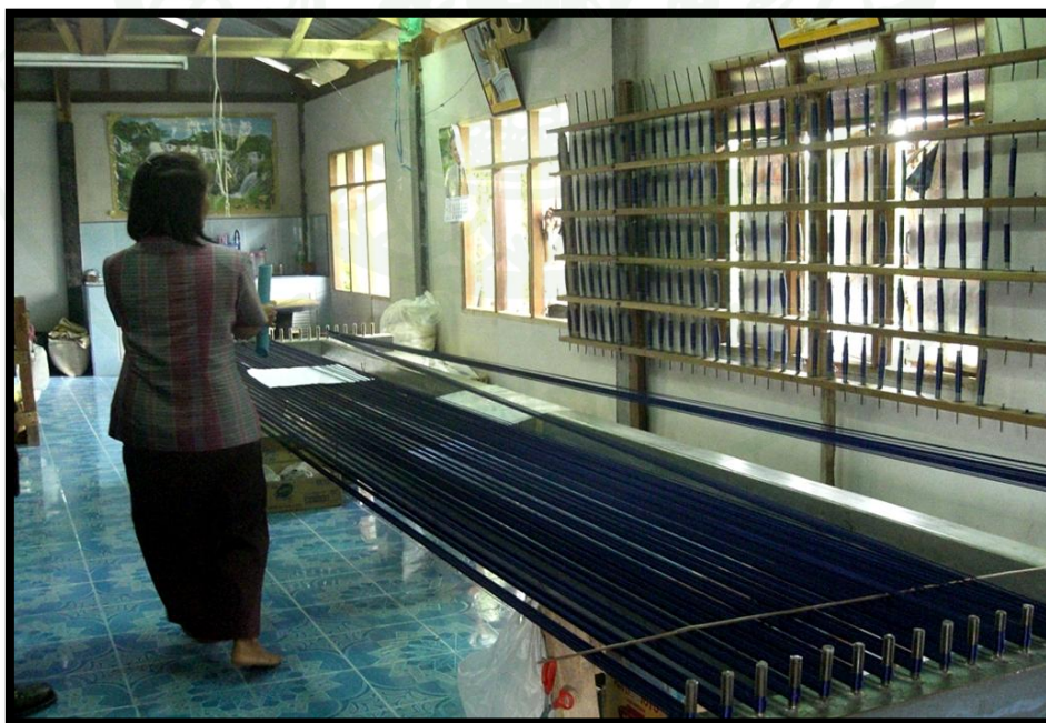
ภาพผนวกที่ 6 การตั้งหลอดไหมและการจูงไหม
