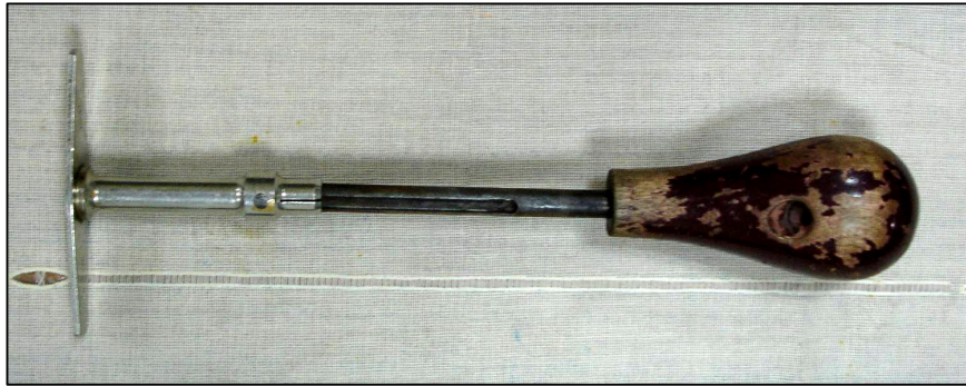
ภาพผนวกที่ 3 เครื่องมือวัดความหนาเปลือกต้นไม้ (Swedish bark gauge)
