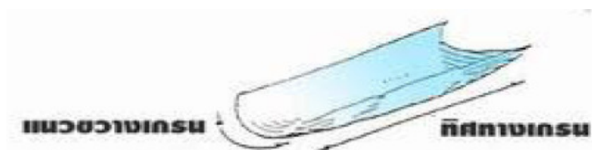
ภาพที่ 2-12 การตรวจสอบทิศทางของเส้นใยโดยการโค้งงอของกระดาษ [20]
