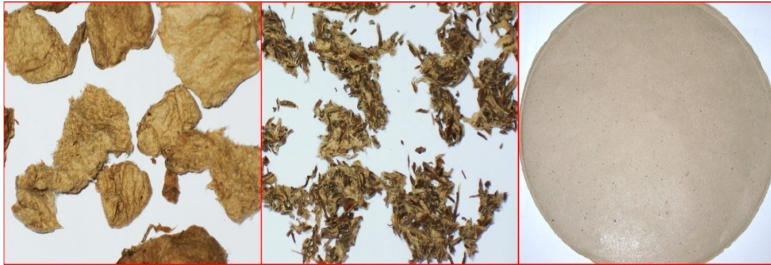
ภาพที่ ก-25 เยื่อที่ต้มที่สภาวะ 147^{\circ}\text{C} , 40% NaOH
