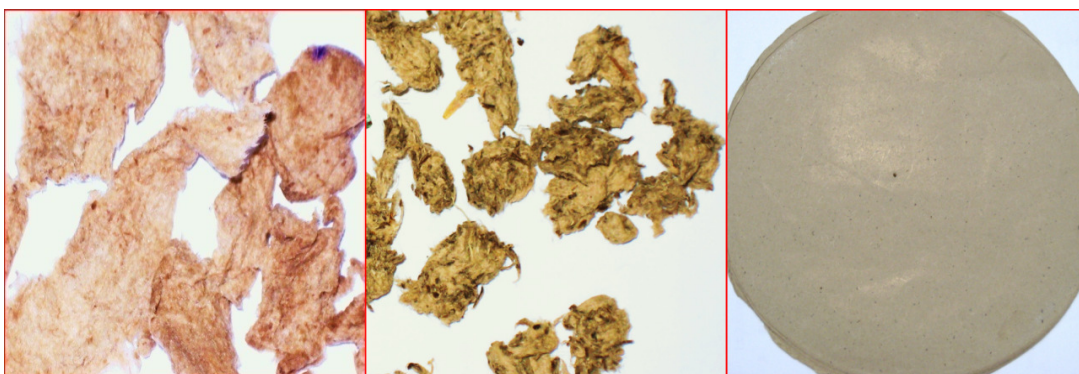
ภาพที่ ค-28 เยื่อที่ต้มที่สภาวะ 155^{\circ}\text{C} , 47% NaOH
