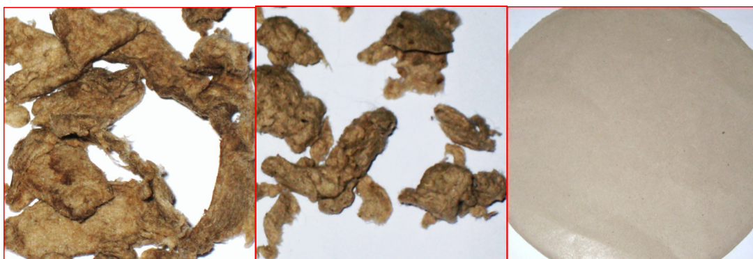
ภาพที่ ค-21 เชื้อที่ต้มที่สภาวะ 165^{\circ}\text{C} , 35% NaOH
