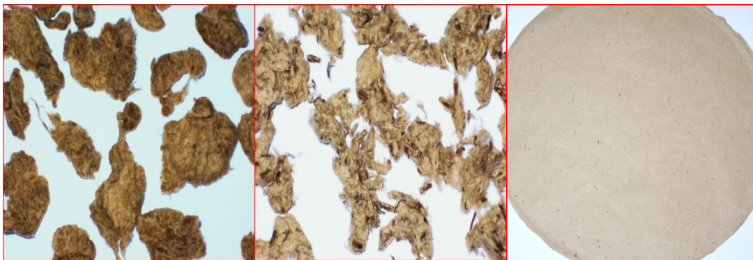
ภาพที่ ก-26 เยื่อที่ต้มที่สภาวะ 168^{\circ}\text{C} , 40% NaOH
