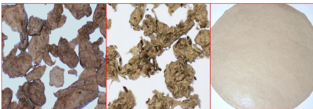
ภาพที่ ค-24 เยื่อที่ต้มที่สภาวะ 155^{\circ}\text{C} , 40% NaOH
