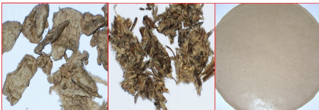
ภาพที่ ค-22 เยื่อที่ต้มที่สภาวะ 150^{\circ}\text{C} , 45% NaOH
