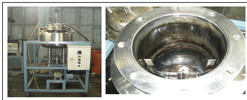
ภาพที่ 3-1 หม้อต้มเยื่อพร้อมชุดควบคุม
