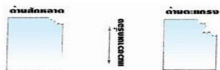
ภาพที่ 2-13 การตรวจสอบทิศทางของเส้นใยโดยการนิกกระดาษ [20]
