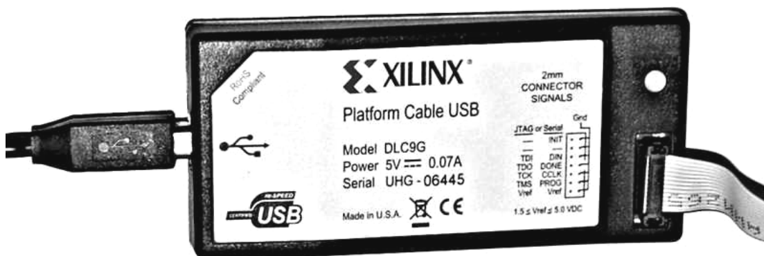
ภาพที่ 12 เครื่องดาวน์โหลดโปรแกรม Xilinx Platform Cable USB
