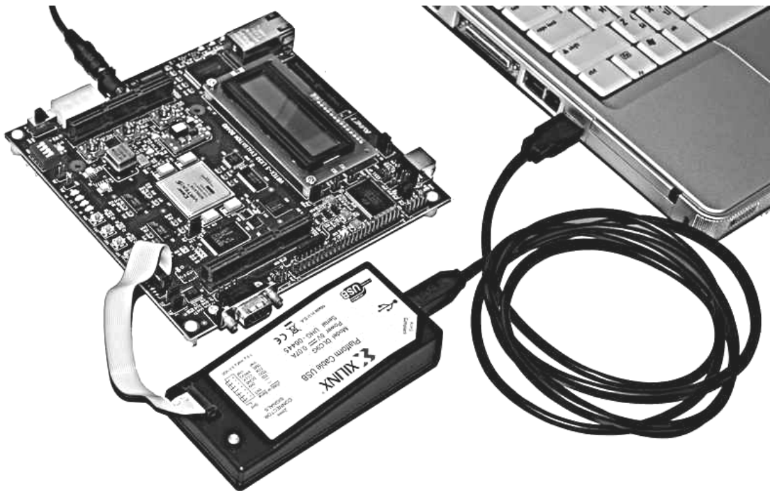
ภาพที่ 15 การเชื่อมต่อประสานอุปกรณ์ สำหรับดาวน์โหลดโปรแกรม
