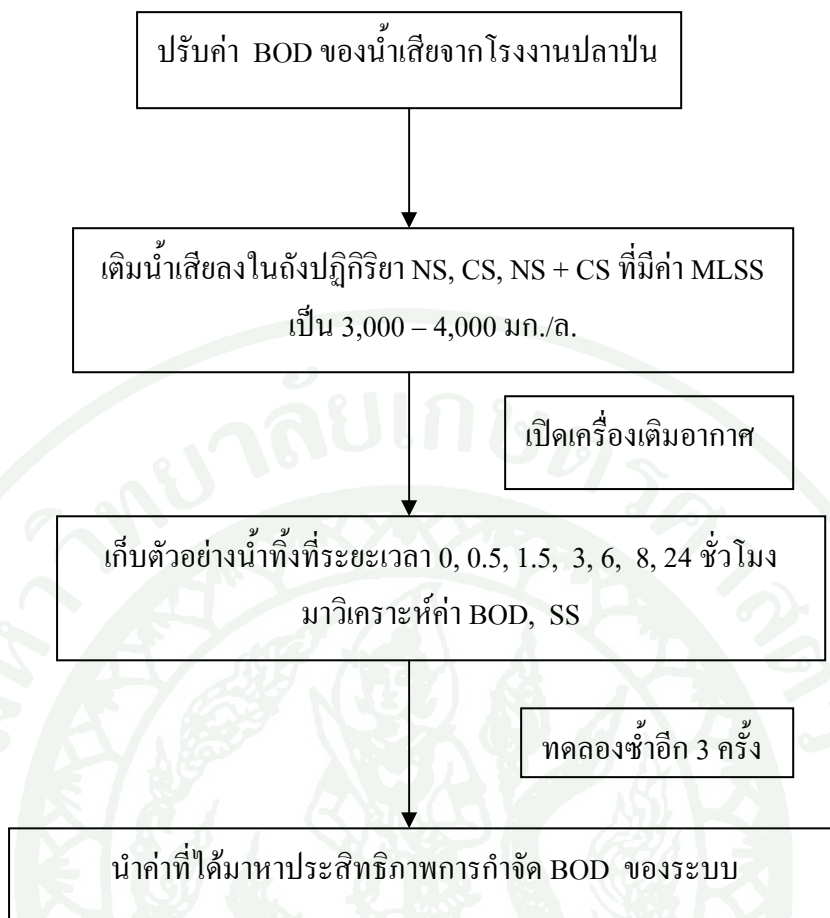
ภาพที่ 8 วิธีการทดลองเพื่อหาประสิทธิภาพการกำจัด BOD ในสถานะสมดุล (Steady state)
