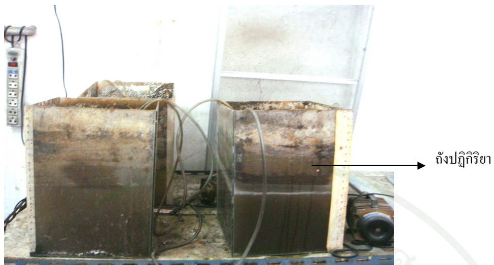
ภาพที่ 5 แบบจำลองถังปฏิกิริยาในห้องปฏิบัติการ
