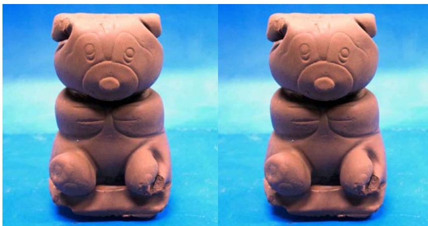
ภาพผนวกที่ ค1 ผลจากการหล่อแบบโดยใช้อีโอโพลีเมอร์ตะกอนเผาที่ 650^{\circ}\text{C} องศาเซลเซียส 100%
