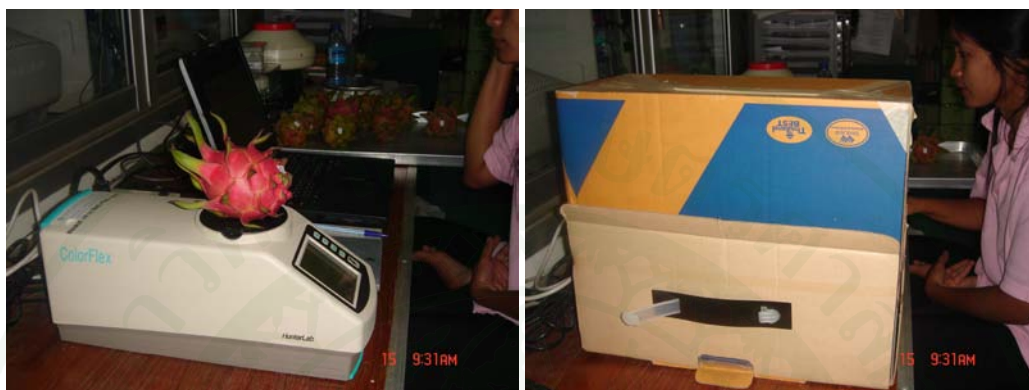
ภาพที่ 37 การตรวจวัดค่าการสะท้อนแสงของผลแก้วมังกรด้วยเครื่องวัดสี Hunter color flex
