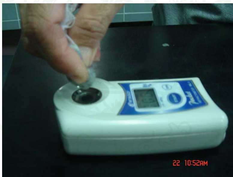
ภาพที่ 7 การวัดค่าปริมาณของแข็งที่ละลายน้ำได้ด้วยเครื่อง Refractometer
