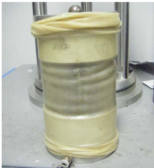
ภาพที่ 22 แสดงวิธีการใส่ถุงยางเพื่อจะให้เกิดแรงดันด้านข้าง (Confining stress)
