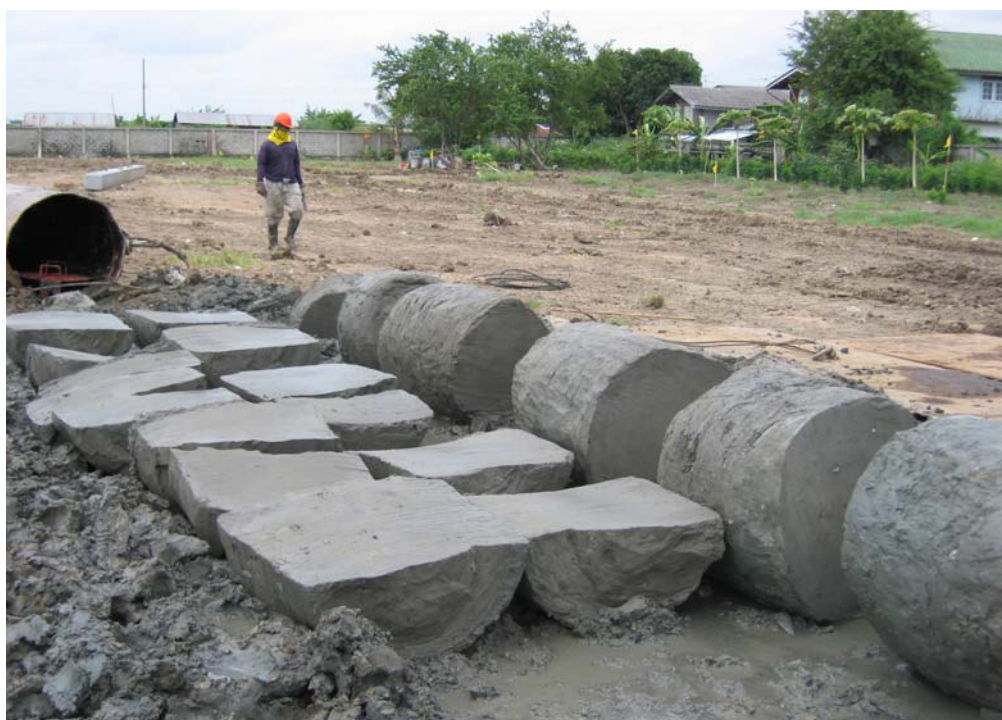
ภาพที่ 17 การทดสอบดึง-ถอนเสาเข็มดิน-ซีเมนต์
