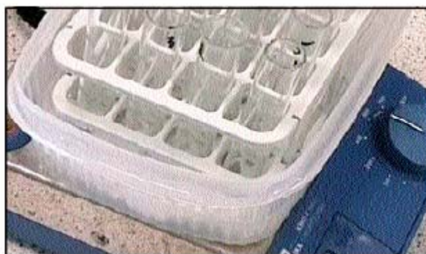
ภาพภาคผนวกที่ 2 ลักษณะการคนตัวอย่างใน lunch box ที่บรรจุน้ำแข็งบน magnetic stirrer
