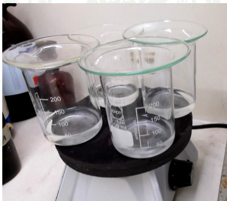
ภาพผนวกที่ ข6 เทคนิคการย่อยตัวอย่างน้ำด้วยวิธีมาตรฐาน US EPA method 3050B
