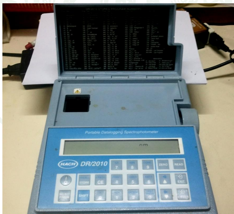
ภาพผนวกที่ ข4 เครื่อง spectrophotometer รุ่น HACH DR 2000/2010
