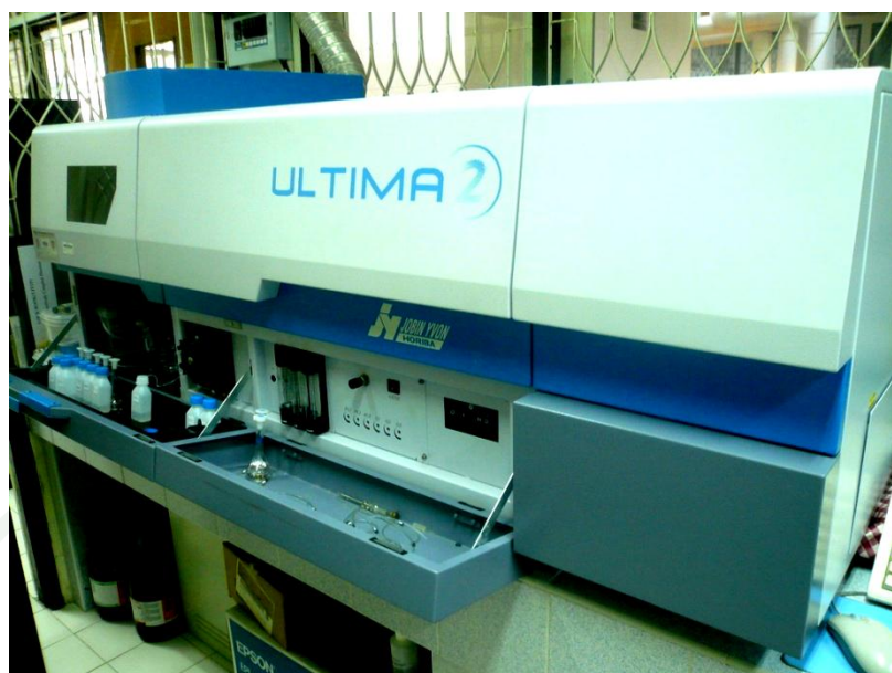
ภาพผนวกที่ ข5 เครื่องตรวจวัดปริมาณโลหะหนัก ULTIMA2, Siamese International group, Italy
