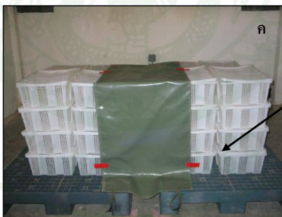
ภาพผนวกที่ ๑1 ตะกร้าทรงสี่เหลี่ยมผืนผ้า (ก) ตะกร้าทรงสี่เหลี่ยมคางหมูซึ่งเป็นบรรจุภัณฑ์ทางการค้าของผลลำไยสด (ข) และการจัดเรียงตะกร้าทรงสี่เหลี่ยมคางหมูเพื่อเตรียมรมซัลเฟอร์ไดออกไซด์ด้วยระบบหมุนเวียนอากาศแบบบังคับในแนวนอน (ค)
